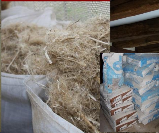
Intérieur : enduits chaux-chanvre en amélioration thermique
